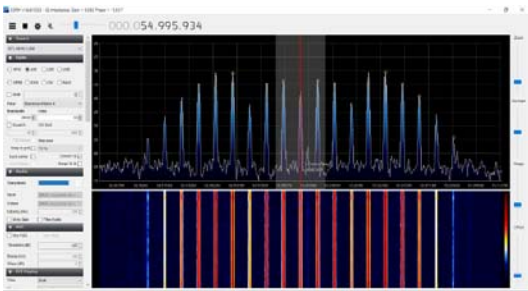
Figura 10. Modulación FM, frecuencia portadora 55MHz, Fbb (frecuencia banda base) 10KHz, índice de modulación, mf=6
