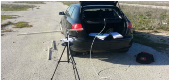
Figura 2. antena YAGUI frecuencia 439MHz
