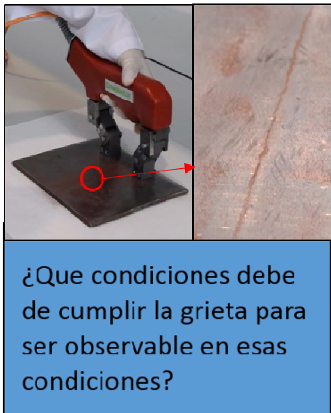
Figura 3. Ejemplo de un fotograma de uno de los vídeos para la práctica de ensayo por partículas magnéticas que muestra un momento del ensayo y la pregunta abierta para la reflexión del alumnado.
