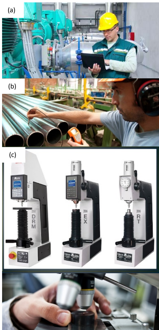
Figura 54. Ejemplos de verificación de calidad de materiales en la industria. a) Operario realizando labores de inspección; b) Mediciones de espesores mediante ultrasonidos; c) Equipos para medir dureza en materiales; d) Microscopio óptico para visualización de microestructuras en materiales.
