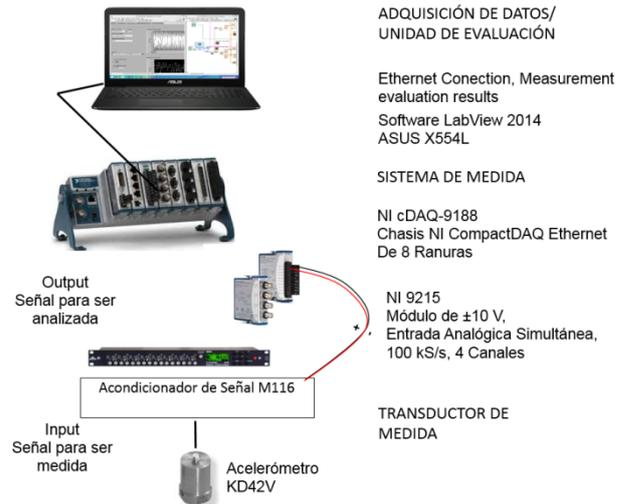
**Figura 30.** Configuración del Instrumento Virtual, que garantiza la trazabilidad de la medición. El hardware consiste en instrumentos certificados, como es el caso de National Instruments. La interfaz en Labview™, mediante el ordenador, permite analizar gráficos en línea, procesar de la señal en tiempo real y reportar incidentes.
