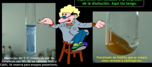
Disolución del G VI constituida por los complejos con Ni(II) de los cationes Ni(II) y Cd(II). Se reserva para ensayos posteriores.
