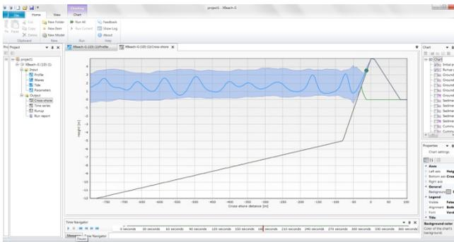
**Figura 5.** Pantalla principal del XBeach-G mostrando la estructura de la carpeta de entrada y salida (izq.), las características del oleaje en un momento concreto de la simulación (centro) y los parámetros de salida (dcha.).
