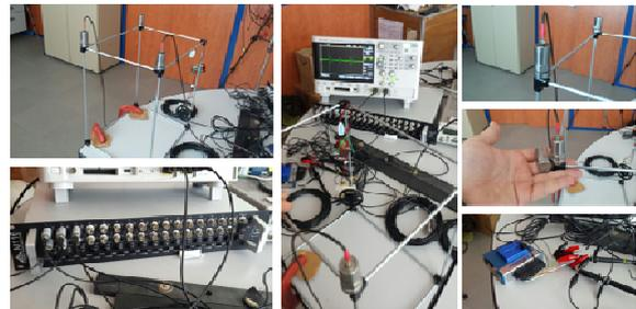
**Figura 2.** Configuración del Instrumento Virtual en el Laboratorio de Instrumentación. Montaje de los elementos del sistema de adquisición de datos.
