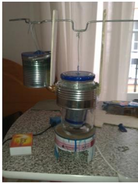
Figura 66. Problema detectado: conexión de biela al pistón. Ej. De soluciones estudiadas
