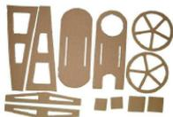
Figura 62. Fabricación de piezas en cartón a partir de los diseños de la etapa 1
