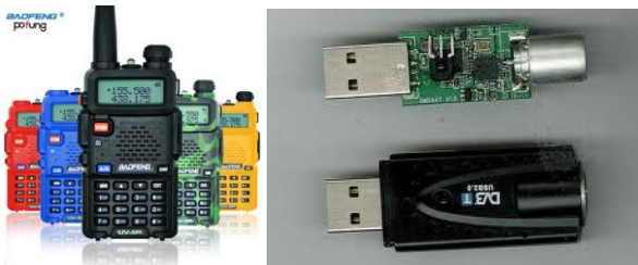
Figuras 11 y 12. Baofeng UV5R y RTL-SDR respectivamente.
